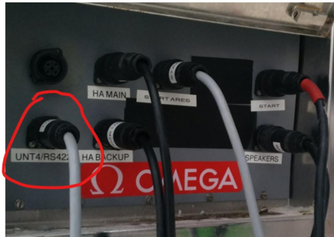
Le câble en rouge est le panneau d'affichage, les autres câbles ne sont plus nécessaires depuis le changement du matériel en 2019 car tout se fait au travers des harnais rouges installés au bord de la piscine.
